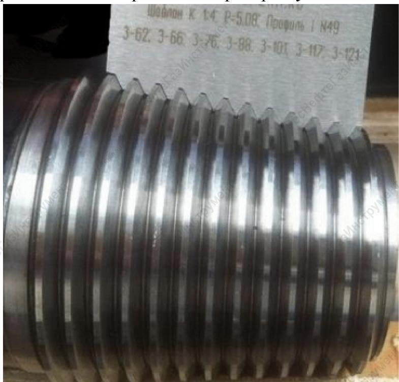
Рисунок 3 - Замер профиля резьбы профильным калибром.
